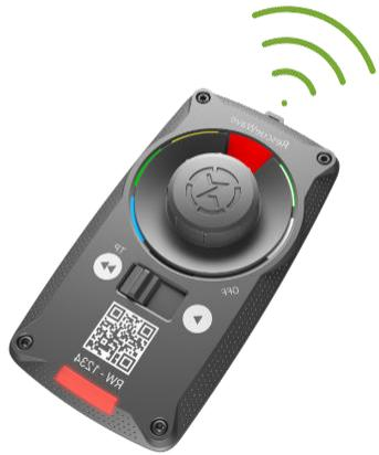
Die automatisierte, digitale Anhängerkarte ermöglicht die automatisierte Weiterleitung von Informationen über jeden Patienten an die Einsatzleitung ohne Zeitverlust: Sichtungskategorie, Standort via GPS, Erstmaßnahmen, Transporthinweise und viele weitere Daten werden unmittelbar im Netzwerk verteilt und stehen allen Führungskräften zur Verfügung.
